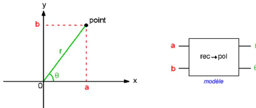
Le principe de fonctionnement est donc simple : on entre les **coordonnés rectangulaires**, ici  $(a, b)$  sous la forme de tensions électriques; on récupèrera les tensions images des **coordonnés polaires**, ici  $(r; \theta)$  sur deux fils en sortie,  $\theta$  étant compris entre  $-\pi$  et  $+\pi$ .
