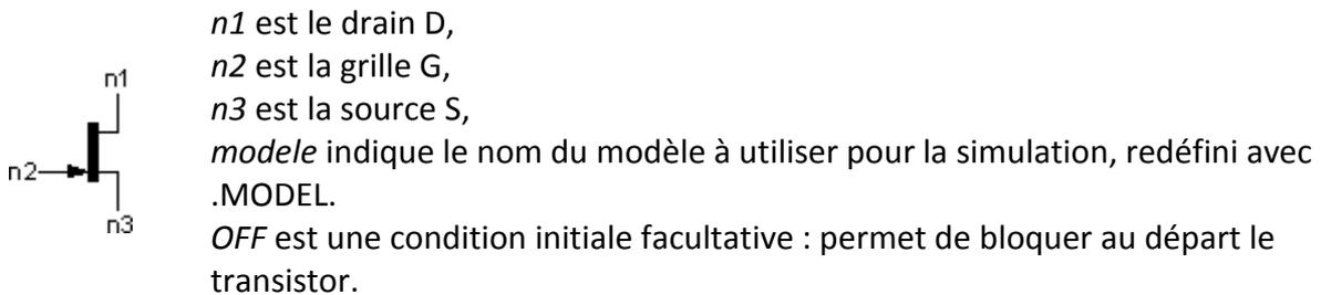
**Redéfinition :** .MODEL nom <NJF ou PJF>(AREA=? TEMP=? VTO=? BETA=? LAMBDA=? IS=? RD=? RS=? CGS=? CGD=? PB=? FC=? B=? KF=? AF=? TNOM=?)
