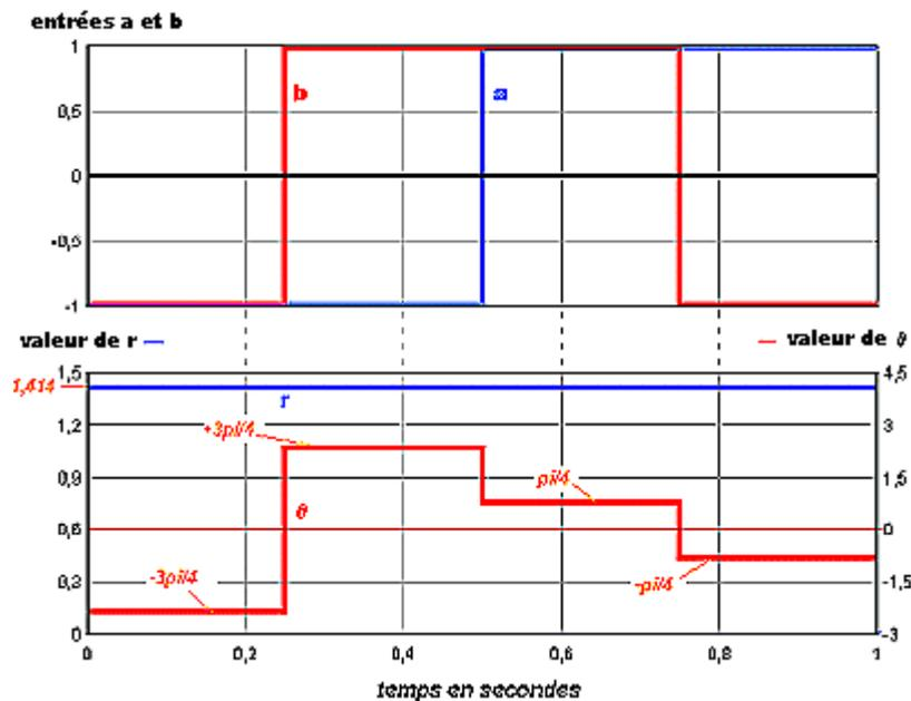
**Conclusion :** le graphe ci-dessus montre que le modèle fonctionne correctement dans tous les cas possibles. On remarque que les coordonnées sont calculées en temps réel par le simulateur. Ce genre de simulation peut dérouter au début car elle utilise des tensions ou des courants pour représenter toutes sortes de grandeurs (comme ici, des angles et des modules), il faut s'habituer !
